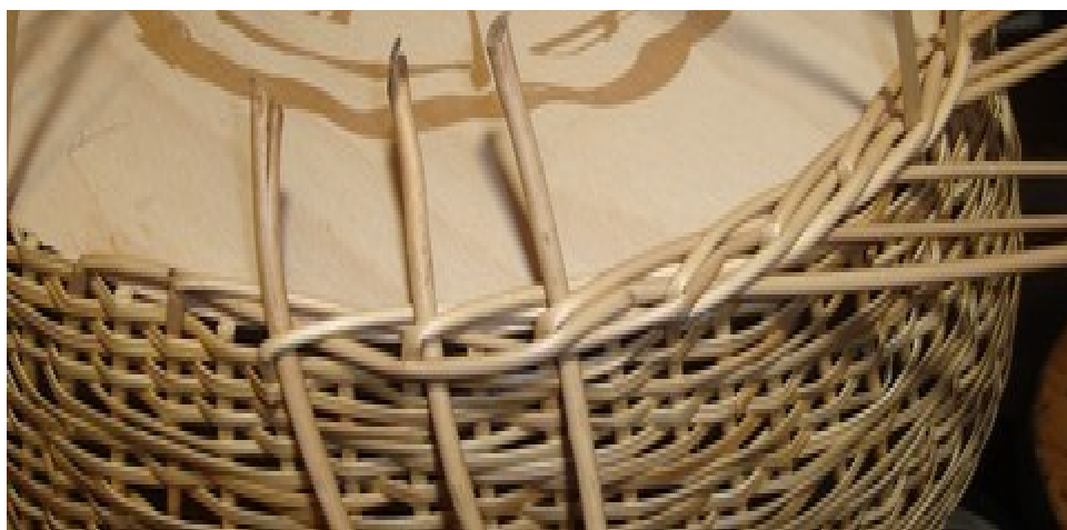
Obr. 72: Uvoľnené pomocné prúty, prvý je pod jedným, druhý je pod dvoma a tretí je pod tromi prútmi. Pomocné prúty spravia miesto pre zasunutie posledných stojákov, lemovka je po celom obvode rovnaká.
